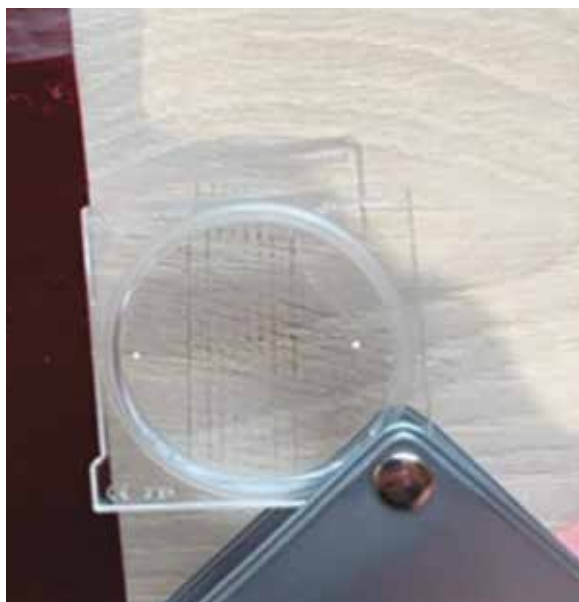
Prova allo strappo UNI EN ISO 2409.
