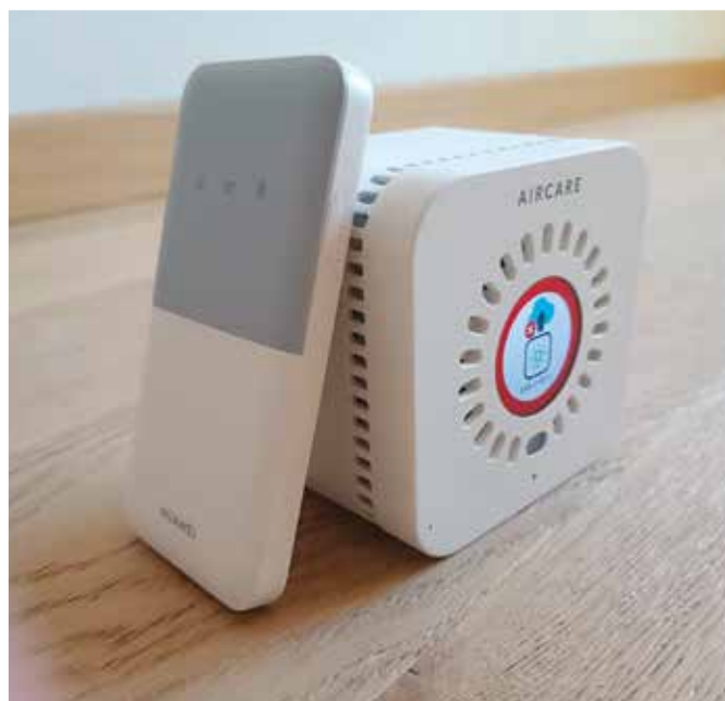
Il sensore Aircare con il router per l'invio dei dati, attivo per tutta la durata dei lavori.
