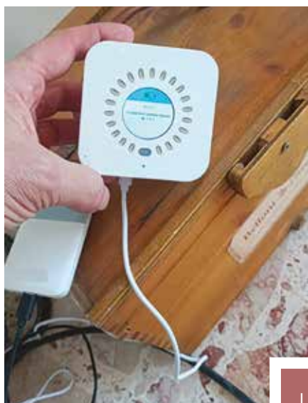
Un sensore multiparametrico per il monitoraggio della qualità dell'aria indoor, dello stesso tipo impiegato negli studi presentati al convegno.
